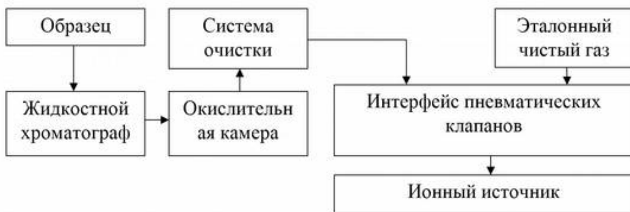
Рисунок 3. Схема анализа жидких образцов с помощью системы «жидкостной хроматограф – изотопный масс-спектрометр» (LC-IRMS).
