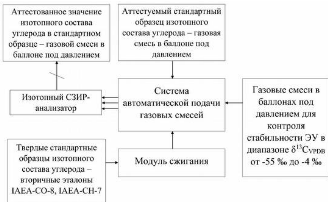
Рисунок 11. Разработанная схема ЭУ для аттестации стандартных образцов изотопного состава углерода – газовых смесей в баллонах под давлением.
