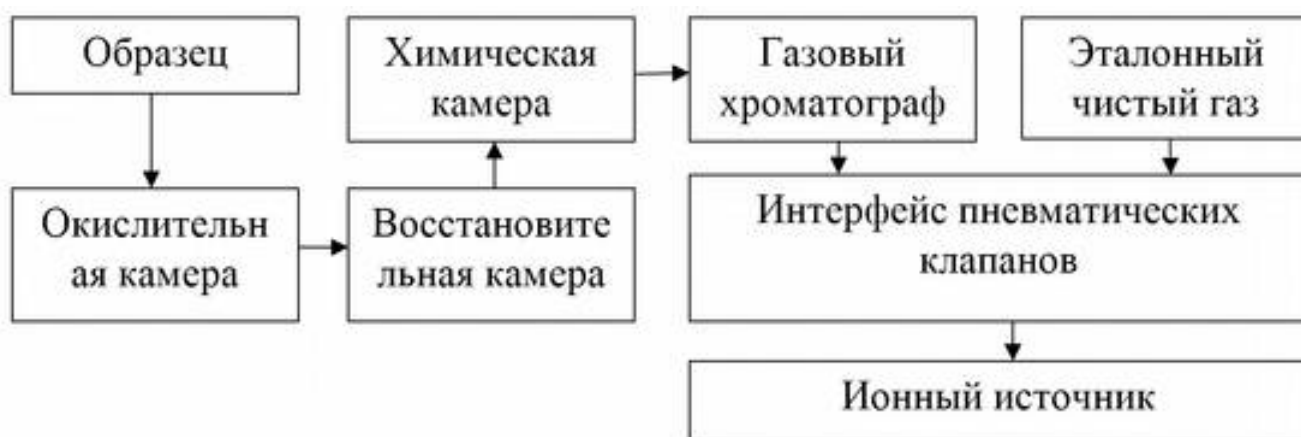
Рисунок 2. Схема анализа твердых образцов с помощью системы «элементный анализатор – изотопный масс-спектрометр» (EA-IRMS).
