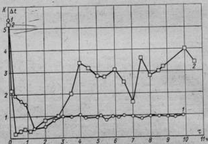
Рис. 1. Изменение яркостной температуры ламп в зависимости от времени при постоянной силе тока. 1 — вакуумная лампа; 2 — газонаполненная лампа.
