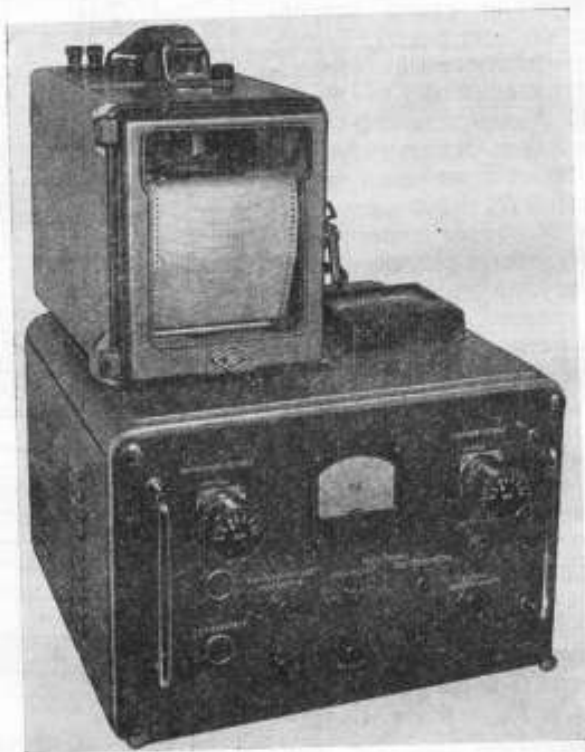
Рис. 3. Устройство для автоматического управления калориметрическим опытом.
