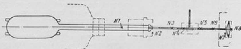
Рис. 6. Распределение термопар № 1—8 по участкам вредного объема газового термометра с резервуаром № С-1 при измерениях в тройной точке воды.
