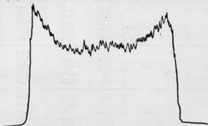
Рис. 7. Распределение активности по поверхности источника.
