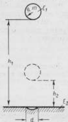
Рис. 40. Схема образования ударного отпечатка.
