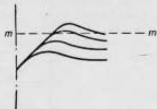
Рис. 34. Искривления прямых под отпечатком конуса.
