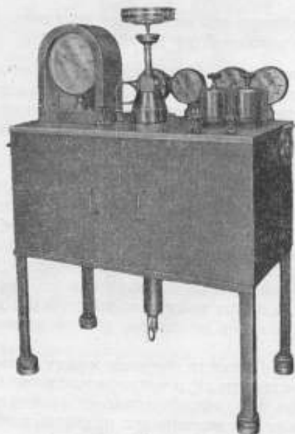
Рис. 3. Общий вид усовершенствованной установки с поршневым манометром М. К. Жоховского до 10000 \text{ кгс/см}^2
