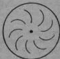
Рис. 6. Схематическое устройство магнетрона новой конструкции.
